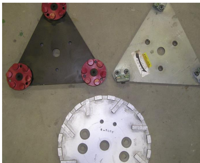
専用機専用研削ダイヤ（#30～40）
