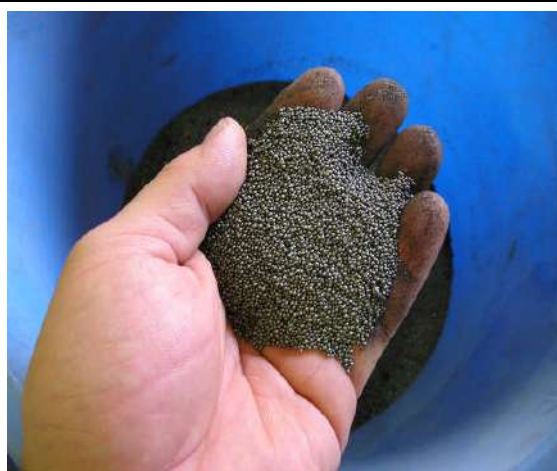
ショットブラスト用メディア 1ミリ程度の鉄球をコンクリートに照射します。
